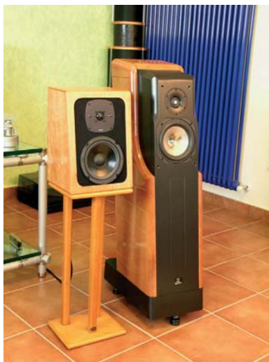
In queste foto si vedono le piccole casse Imago, senza e con il subwoofer Vis, poste a fianco al "riferimento" impiegato in questa prova. Il baffle frontale delle Rosa, inclinato, è ricoperto con uno spesso strato di feltro per ridurre rifrazioni improprie.
