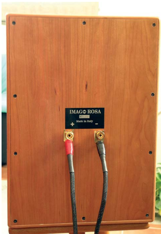
I morsetti, in ottone dorato 24k, nella versione standard delle Rosa sono solo due, quindi i diffusori non sono atti al bi-wiring. Le casse Imago possono essere tutte realizzate e rifinite anche secondo particolari esigenze del cliente.
